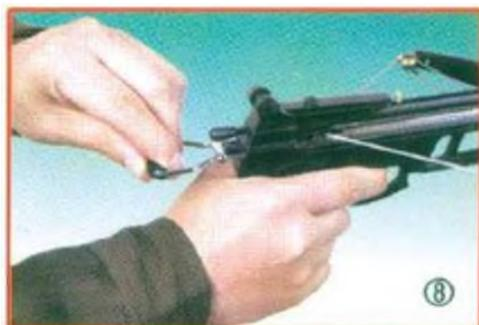
Регулиране на прореза и мерника: Можете да регулирате оста на прореза с помощта на винтовете отстрани. Можете да регулирате мерника според разстоянието на целта. Фиг. 9.
